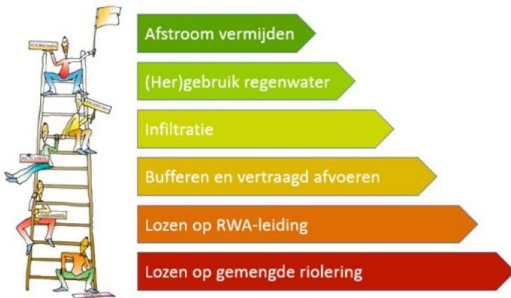
figuur 1. De Ladder van Lansink voor het omgaan met regenwater (bronmaatregelen)
